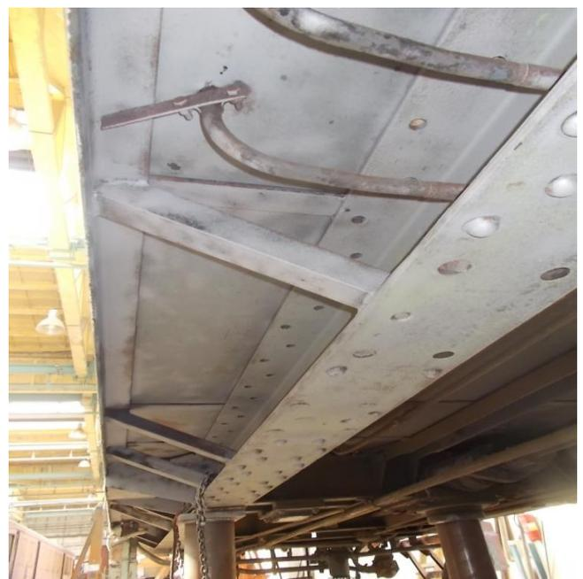
**Die Unterseite nach dem Sandstrahlen**
