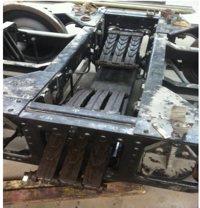
**Einbau der aufgearbeiteten Blattfederpakete**
