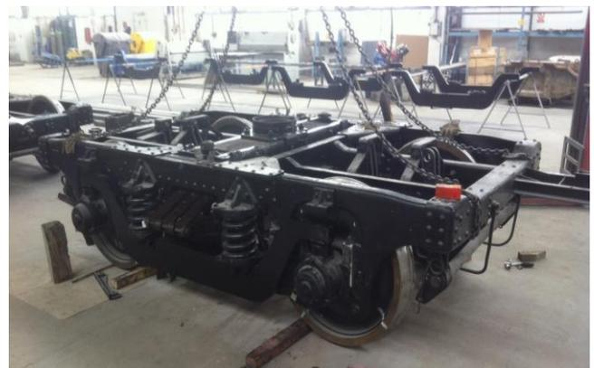
**Fast einbaufertiges Drehgestell**
