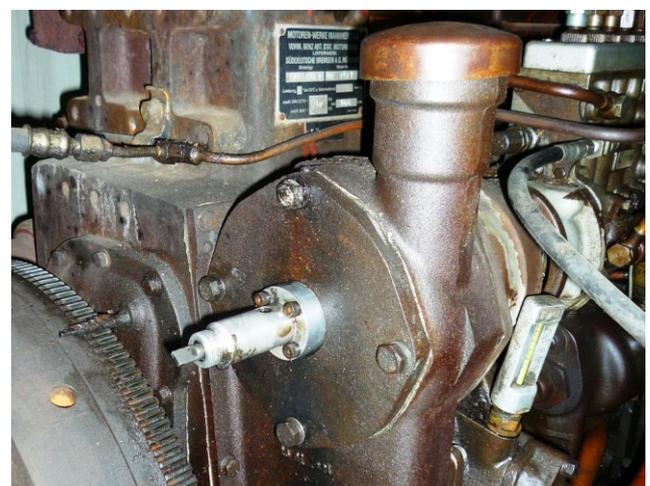
Da wird die Motorendrehzahl „abgezapft“
