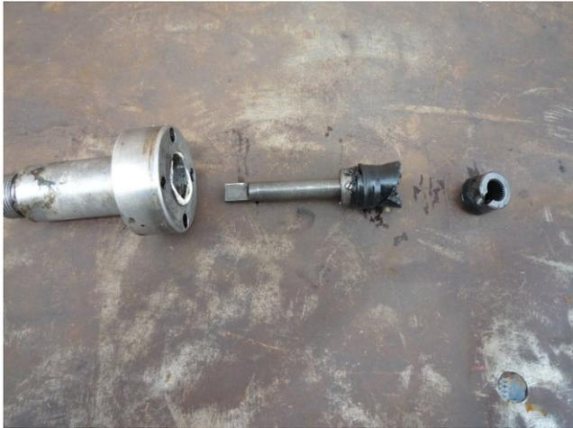
Kleine Welle mit „Schwingungsdämpfer“ aus Gummi? Das ist das defekte Teil...
