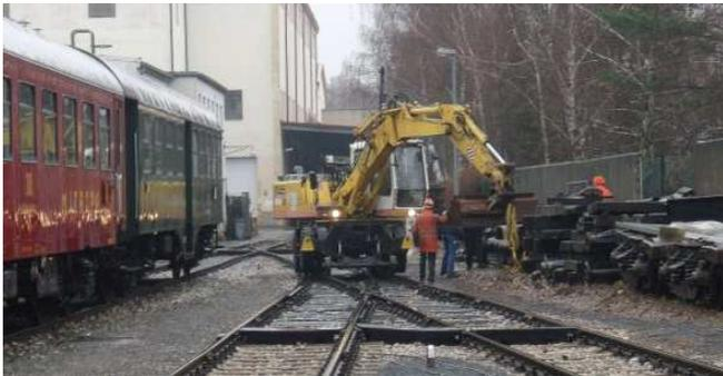
Das „neue“, wendige Kraftpaket im Einsatz schweren Teilen an Lokomotiven und Wagen, fürs Laden von Schlacke und – höchst aktuell – für die umfangreichen Erdarbeiten zum Gießen der Fundamente der Fahrzeughalle (s. u.).
