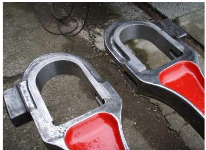
Sodann wurden die Lagerschalen in die Stangenschlösser eingepasst und die Lager neu ausgegossen.
