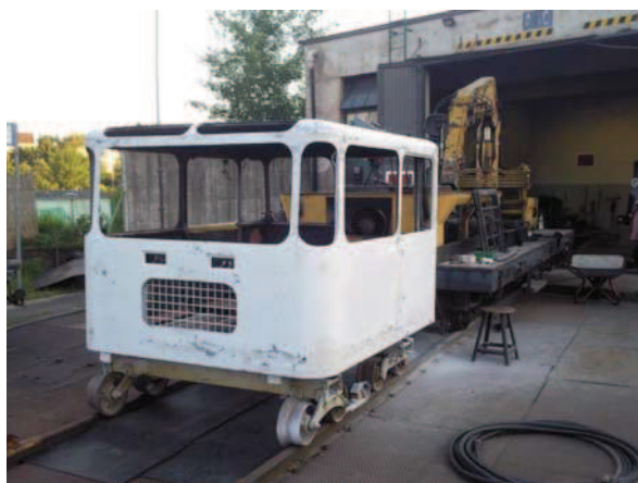
Nun muss das Fahrerhaus wieder auf die „Maschine“!
